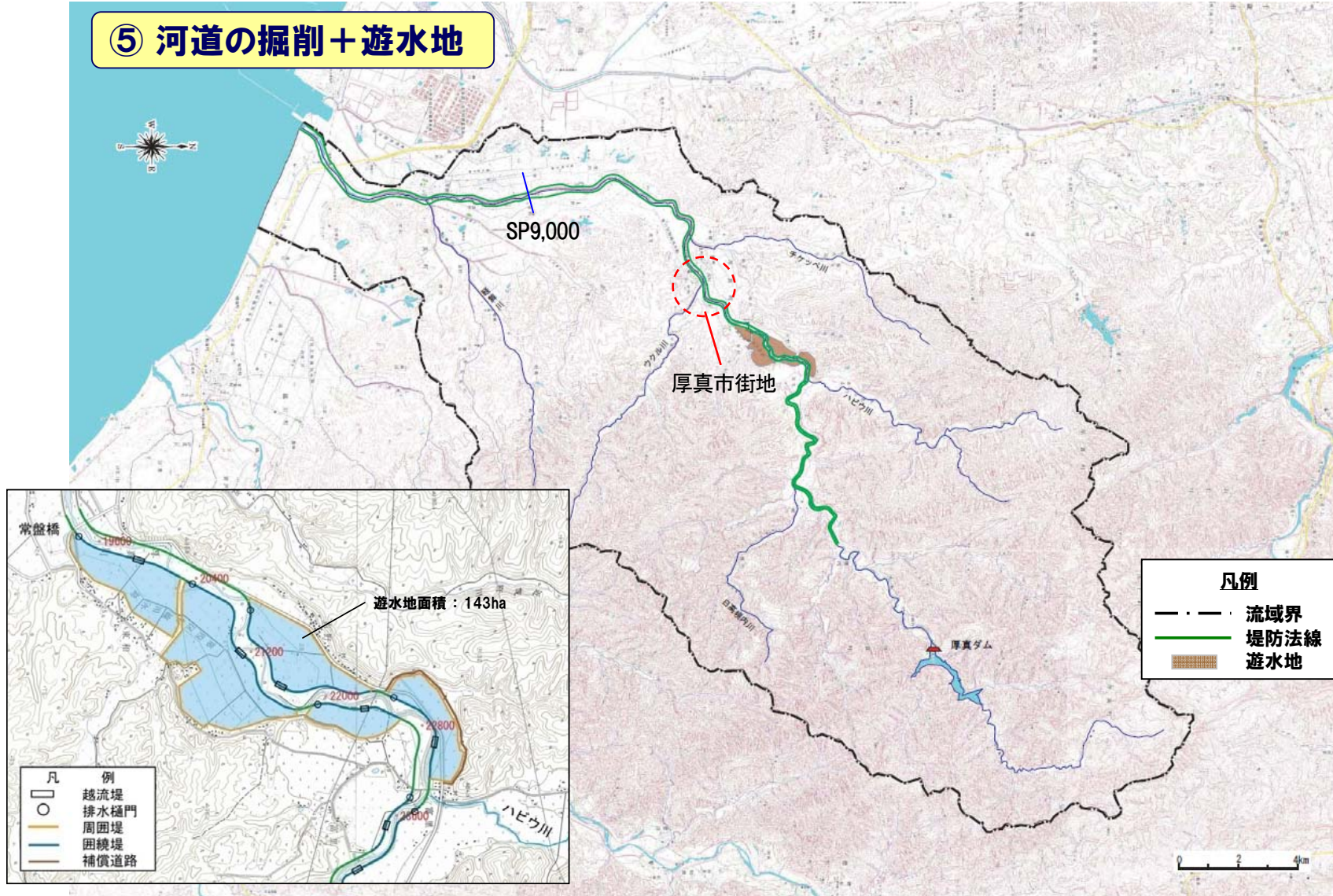
図 5.2.19 対策案概要図（河道の掘削+遊水地）
