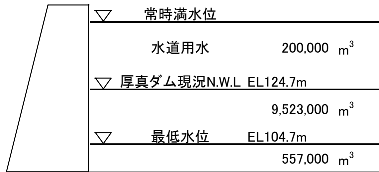
図 6.4.5 ダム再開発（厚真ダム掘削）の容量配分図
