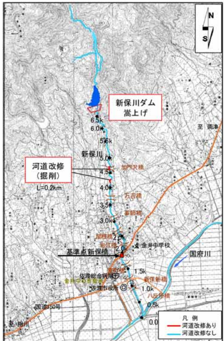
図 4.3.4 ダム嵩上げ+河道改修案の概要
