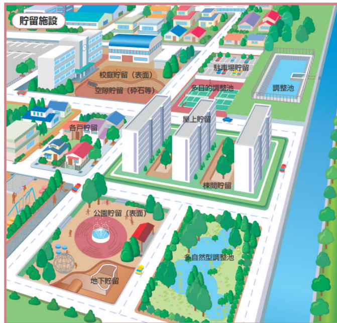
図 4.39 雨水貯留施設の種類
