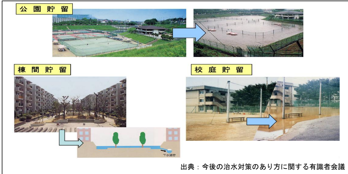
図-4.2.16 雨水貯留施設のイメージ
