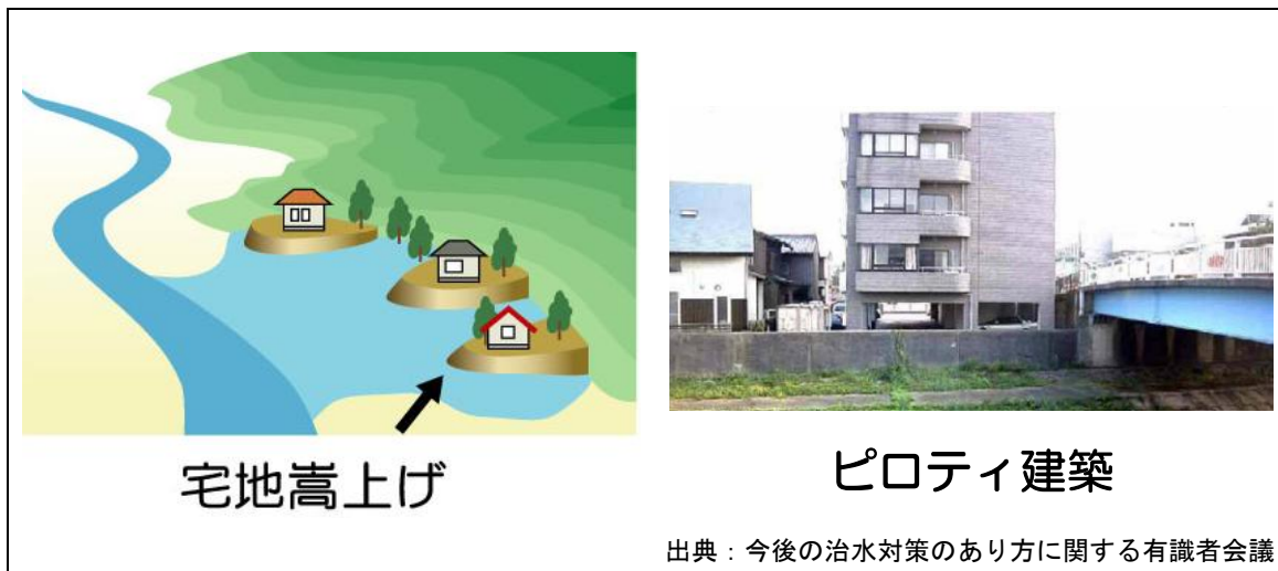
図-4.2.24 宅地かさ上げ、ピロティ建築等のイメージ
