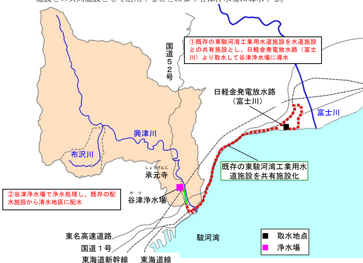
図 5.46 水系間導水案（B'案：水利権を取得して既存工業用水道施設を活用）の概要
