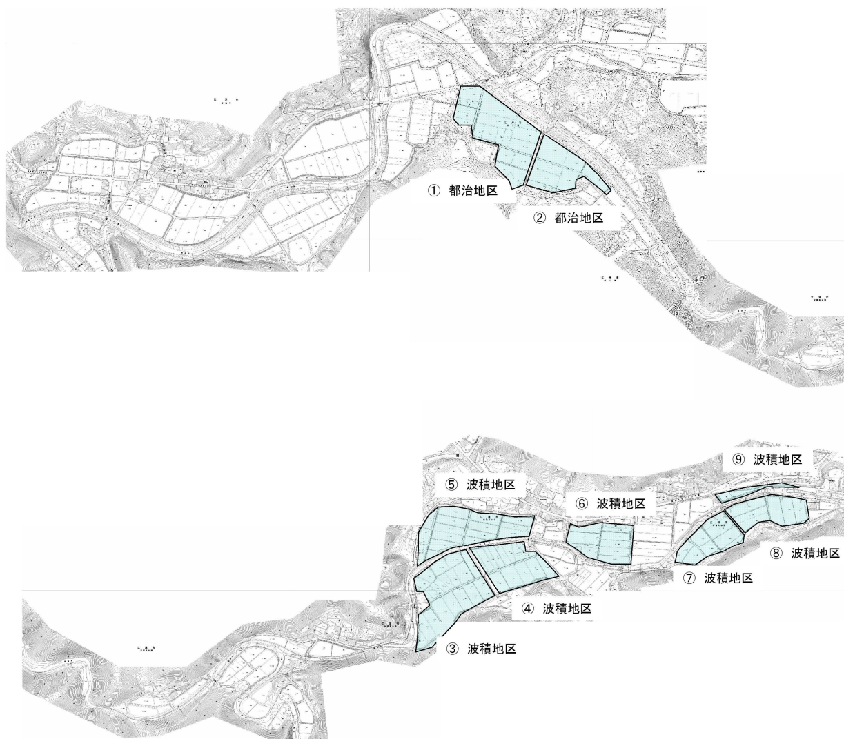
図 4.7.3 河道外貯留施設建設位置
