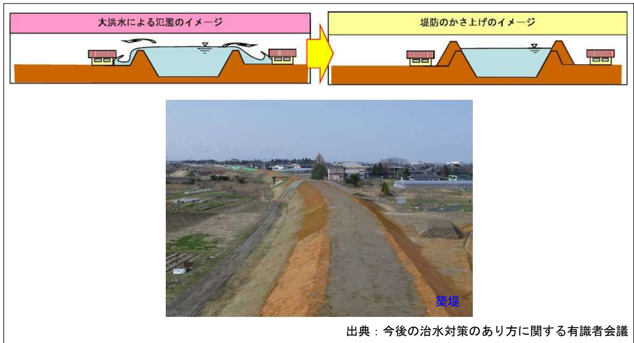
図 4.2.10 堤防のかさ上げのイメージ
