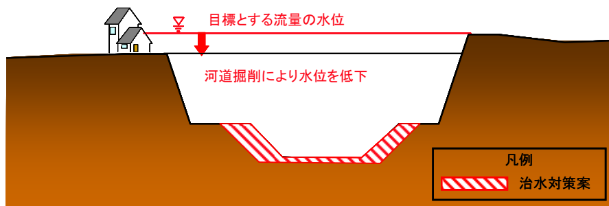
図 4.2-11 掘削断面のイメージ (県管理区間)
