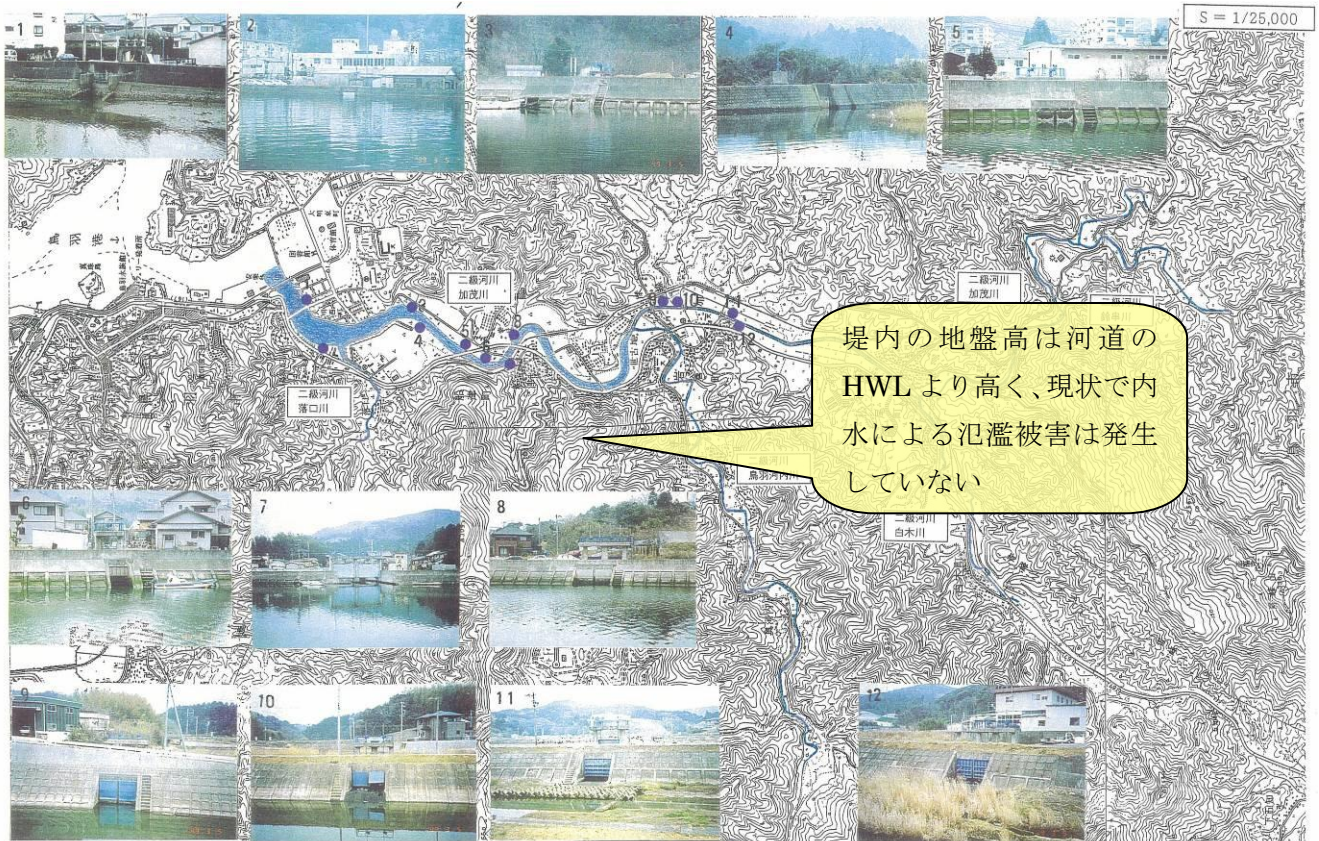
図 4.3.5 加茂川流域の樋門・樋管の設置状況
