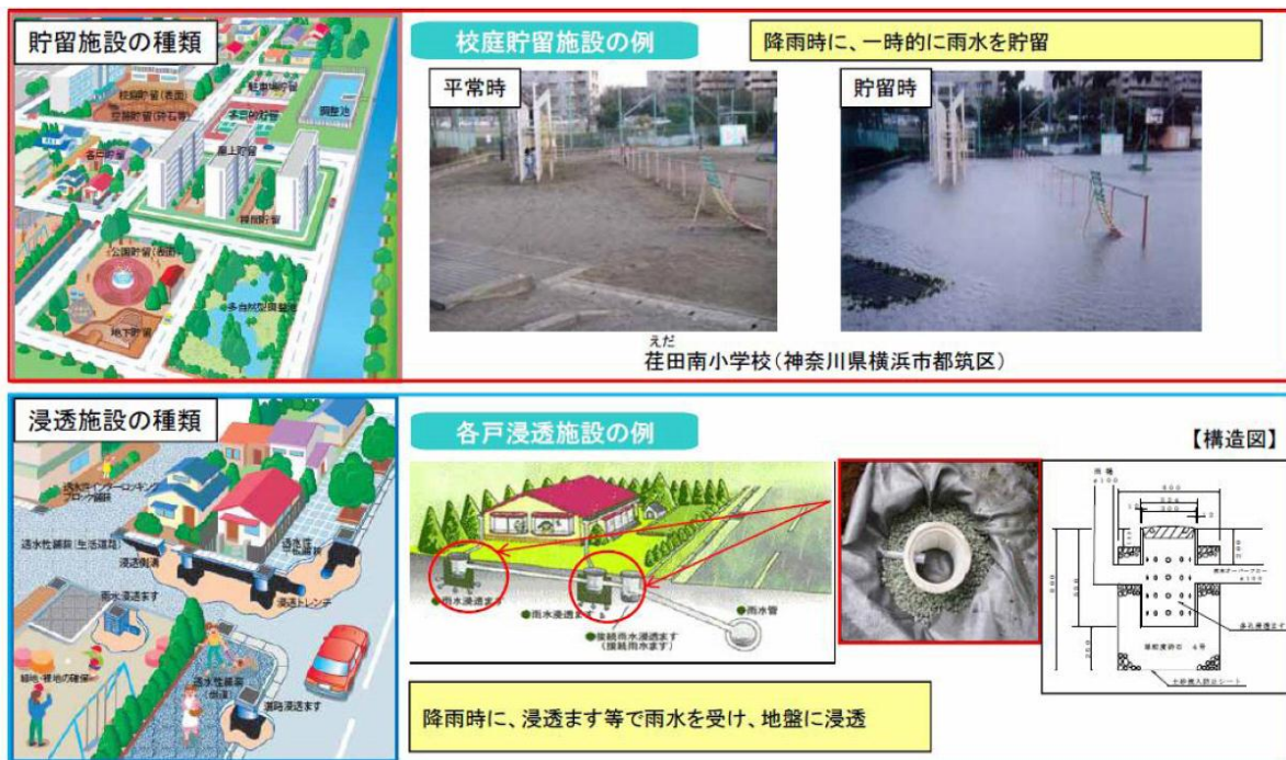
図 4.3.6 雨水貯留・浸透施設概念図（有識者会議資料）
