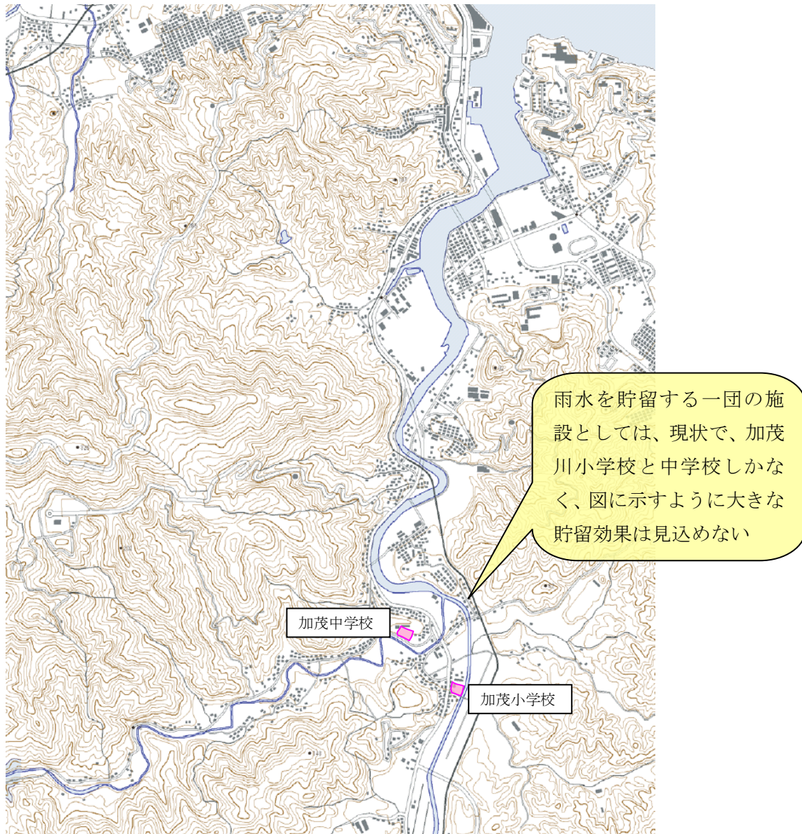
図 4.3.7 加茂川流域の雨水貯留施設の設置箇所
