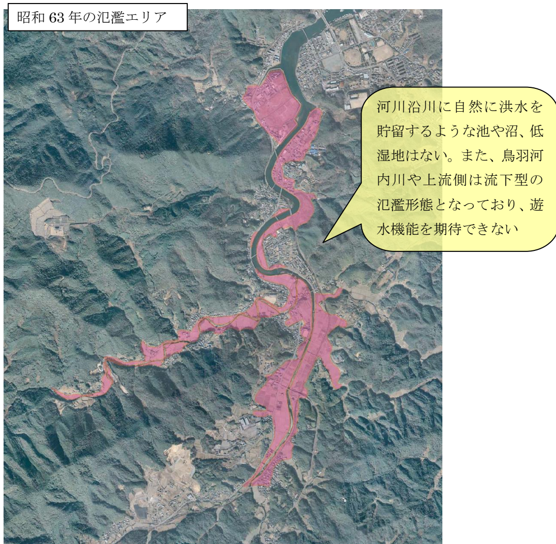
図 4.3.10 加茂川流域と氾濫エリア
