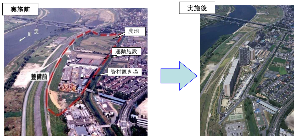
図 4.2-18 高規格堤防の実施例
