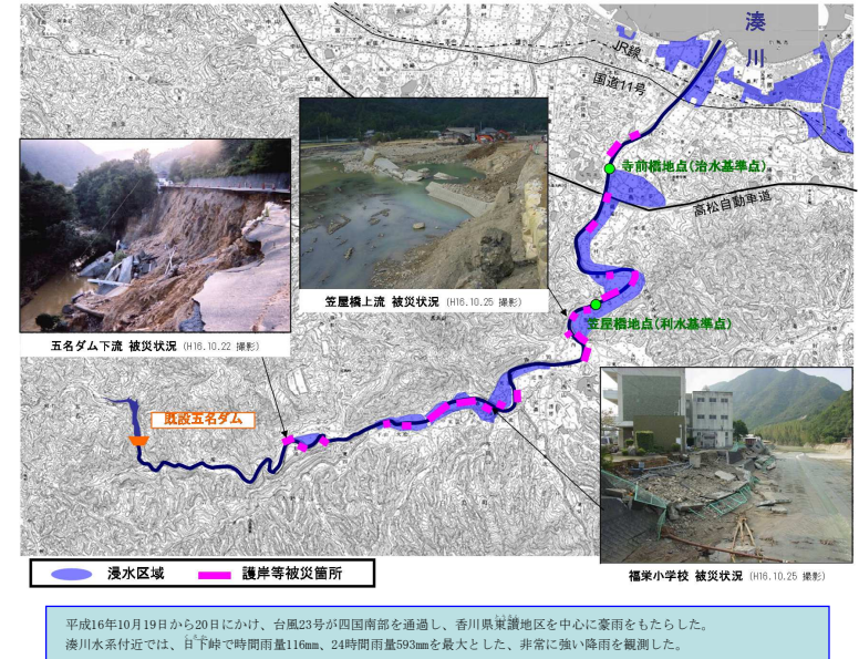
図-2.4 平成16年台風23号洪水の被災状況
