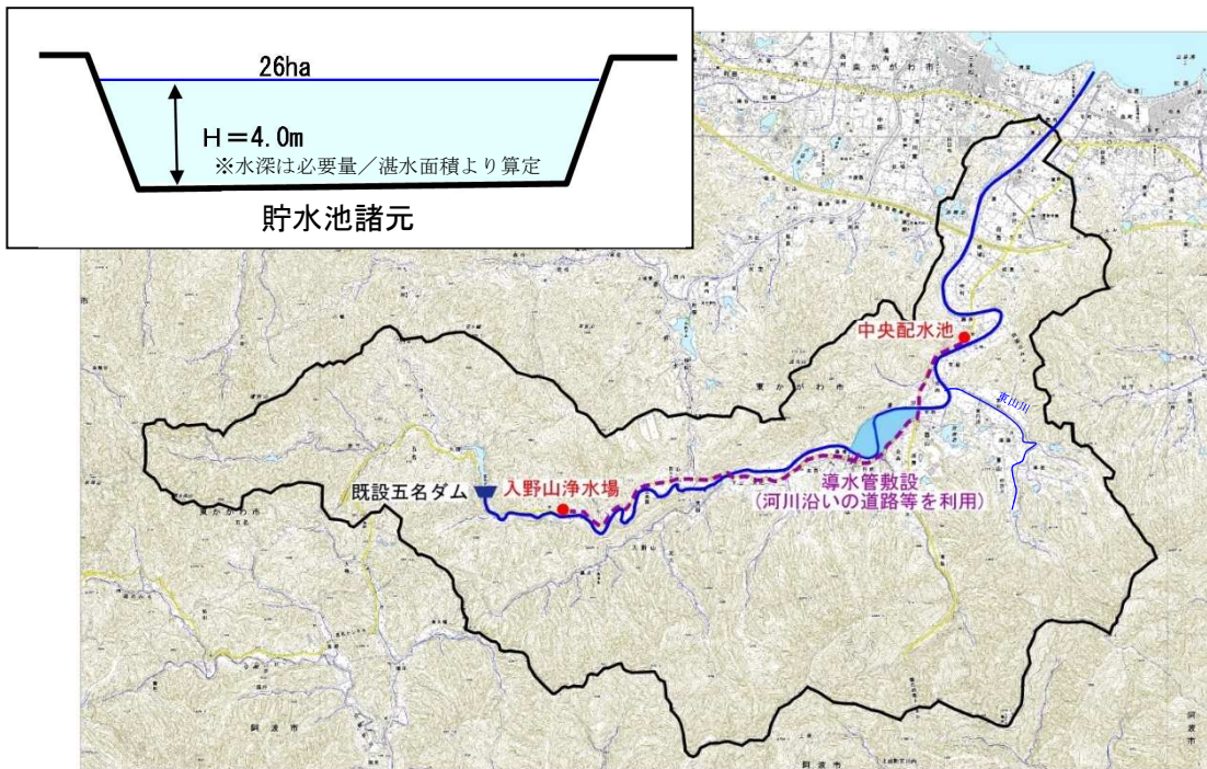
図-4.3.25 位置図及び諸元（河道外貯留施設）
