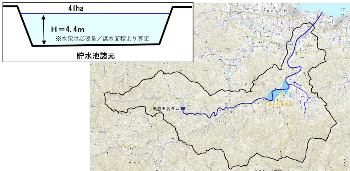
図-4.4.24 位置図及び諸元（河道外貯留施設）
