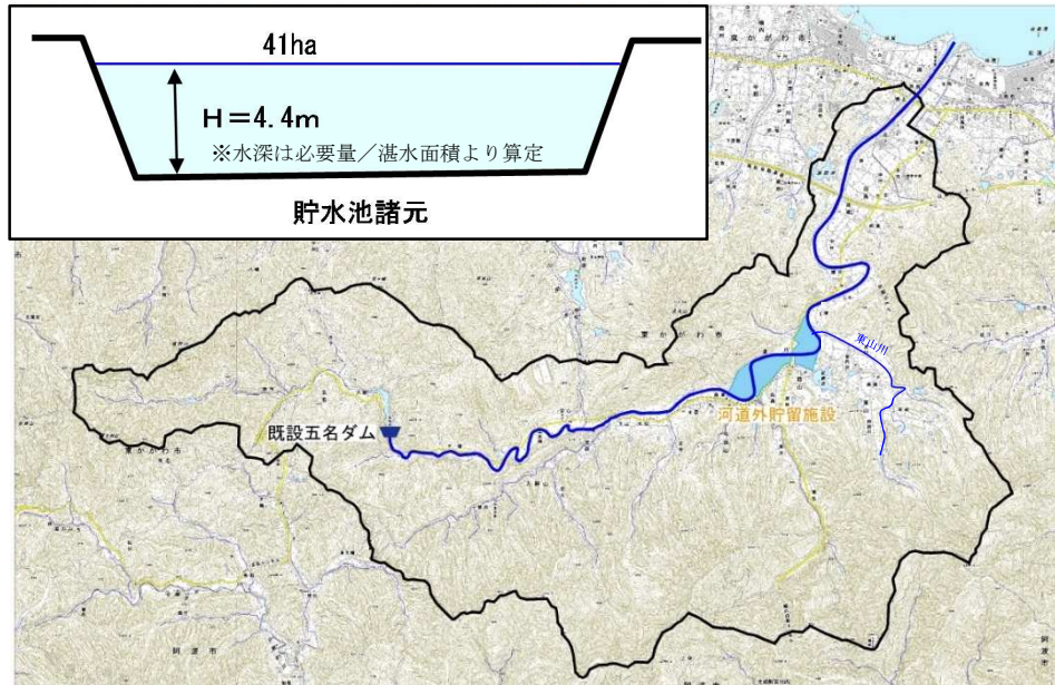
図-4.4.18 位置図及び諸元（河道外貯留施設）
