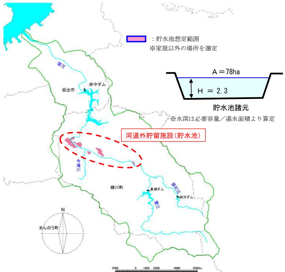
図-4.3.5 綾川流域における河道外貯留施設（貯水池）の候補地
