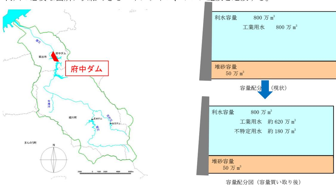
図-4.3.19 位置図及び諸元 (他用途ダム容量の買い上げ)
