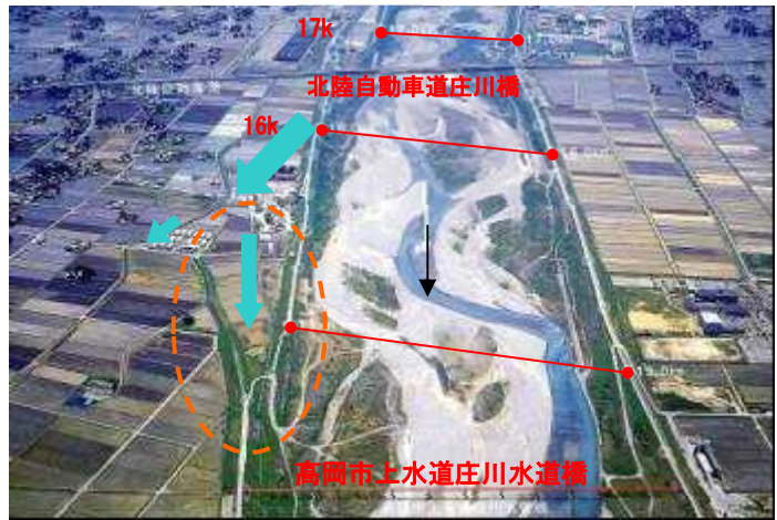
破堤した場合の氾濫水の流れ
