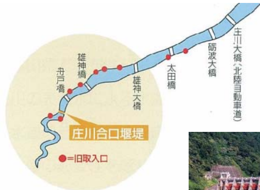
昔の取水口の位置と現在の合口堰堤
