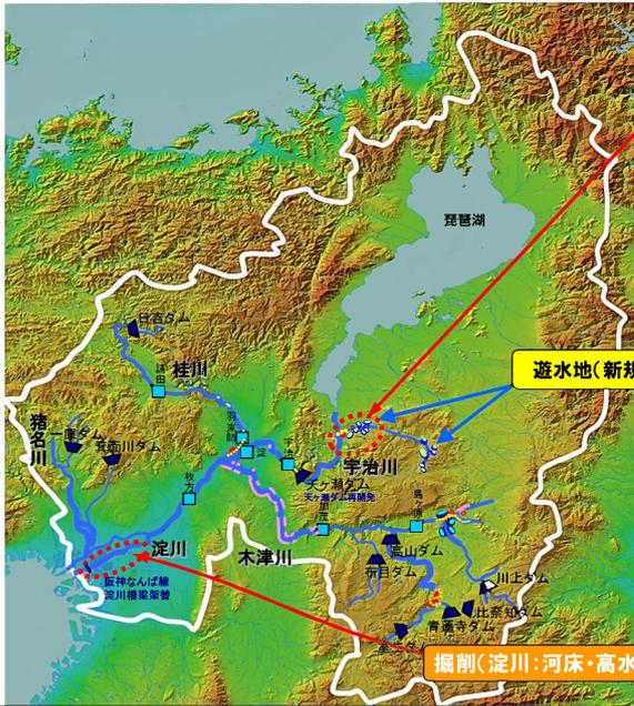
淀川は3.8km、大戸川は7.5kmにわたりH.W.L.を超過するため、大戸川沿川の田上地区および黄瀬地区の新規遊水地により洪水流量を調節するとともに、大戸川の吉祥寺川合流点から上流においては310m<sup>3</sup>/s増となるよう堤防のかさ上げを行う。淀川本川では約100m<sup>3</sup>/s増となるよう河道を掘削を行う。
