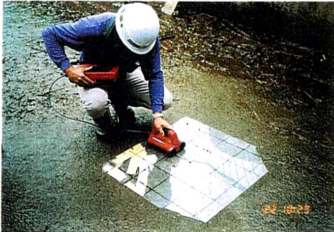
写真-15 鉄筋探査器による測定状況
