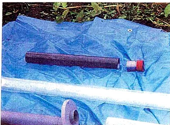
写真-21 鋼製保護管およびキャップ
