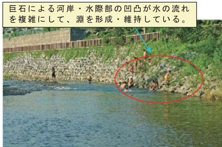
写真 4.19 河岸の凸部が淵を形成している例（平井川：東京都）
