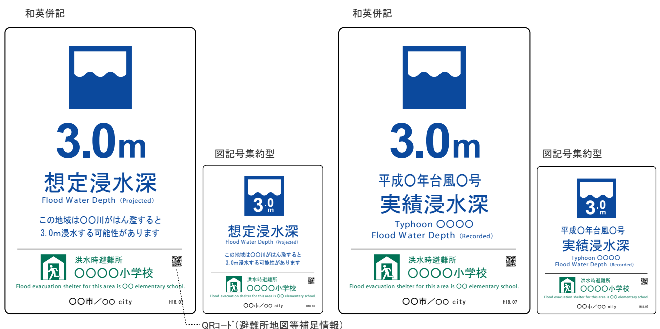
図-7 洪水標識（避難所図記号の併記）板面表示例
