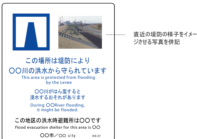
図-14 堤防標識板面表示例
