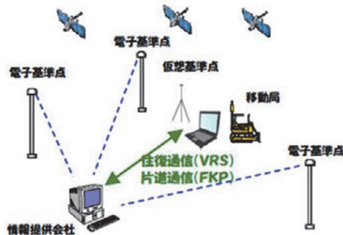
図22-3-8 ネットワーク型 RTK 方式概念図
