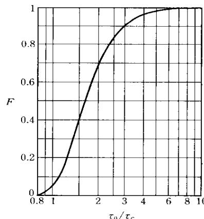
図 6-3-1 佐藤、吉川、芦田の式における  $F$  と  $\tau_0 / \tau_c$  との関係無次元限界掃流力  $\tau_{*c}$  は、式(6-3-15)に示す岩垣式により算定することができる。
