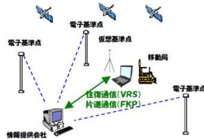
図 22-3-8 ネットワーク型 RTK 方式概念図
