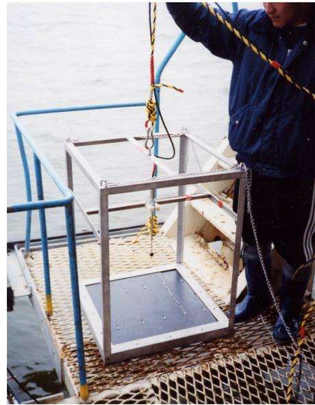
写真 6.4.2 電磁流速計の架台
