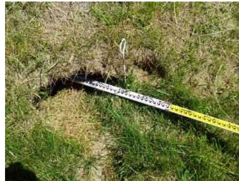
図 2.6 深さ 4 m 近く計測されたキタキツネ穴の実態
