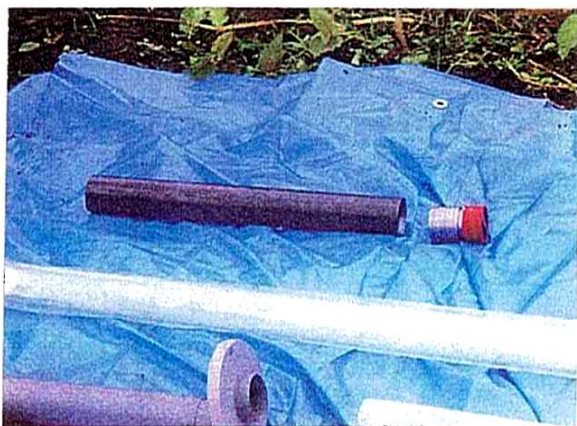
写真-21 鋼製保護管およびキャップ
