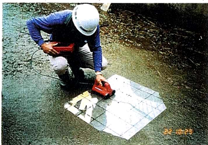
写真－15 鉄筋探査器による測定状況
