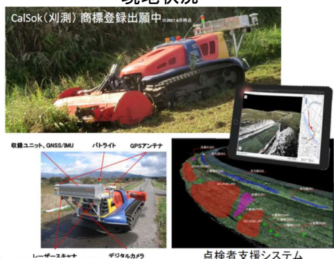
アタッチメント型 LP を活用した堤防点検
