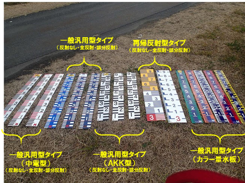
写真 3 市販されている一般汎用型の水位標の例
