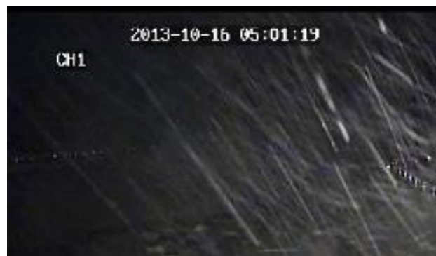
写真 2 CCTV カメラの横に設置された照明器具によるハレーションの事例
