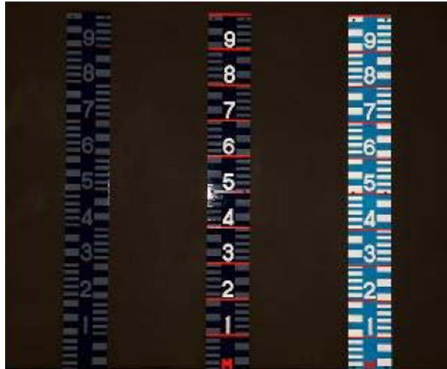
写真 4 夜間時の一般汎用型の無反射型・部分反射型・全反射型による見え方の違い
