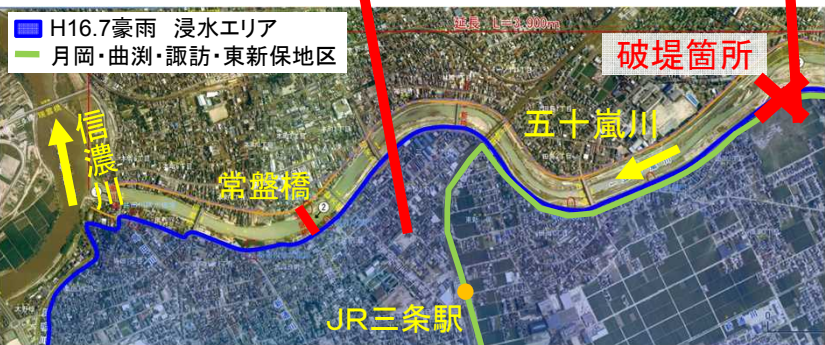
三条市街地の浸水状況
