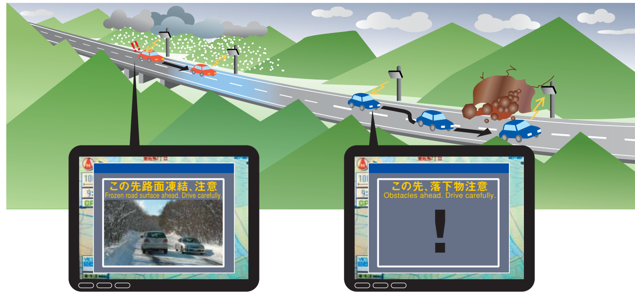
プローブ情報の収集と提供(路面状況を収集するプローブの例) Collection and provision of probe data (Example of probes for monitoring road surface conditions)
