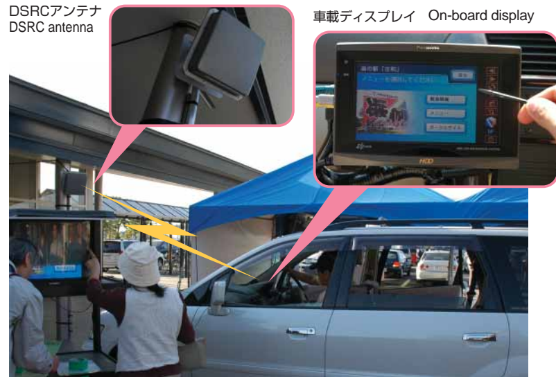
車載ディスプレイに表示される情報を車外のモニターでも表示 Information displayed on the on-board display was also displayed on a display outside the vehicle
