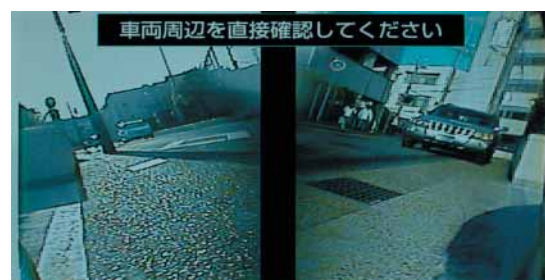
フロントカメラによる前方左右映像の同時表示 Simultaneous display of the front right and left from a front camera
