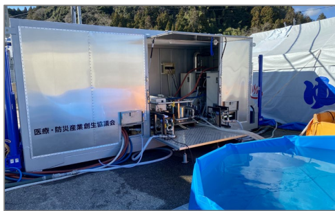
図 46 ボイラーコンテナによる入浴支援 (七尾市崎山地区コミュニティセンター)
