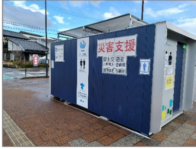
図 42 搭載型のトイレコンテナ (道の駅「あなみず」)
