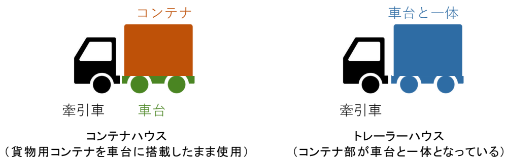
図 19 牽引型の高付加価値コンテナの概要
