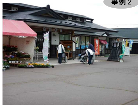
▲トイレまでの動線上に段差がない事例
