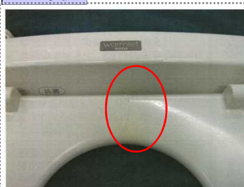
▲材質の種類に合わない洗剤を使用し、材質が劣化して破損した事例
