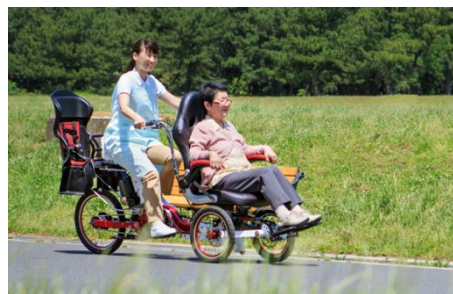
介護用から宅配用まで幅広い使い方ができる前2輪電動アシスト自転車を開発(TRIKE CARRY 前輪2輪電動アシスト自転車)【出典：豊田TRIKE(株)】
