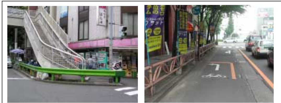
色彩の彩度が高く、周辺景観から浮立った印象となっている防護柵の例
