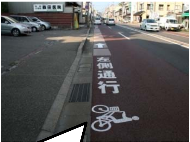
バスレーンに自転車の通行位置と通行方法(左側通行)を明示することで安全性を確保
