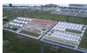
塗料の暴露試験状況(宮古島)
