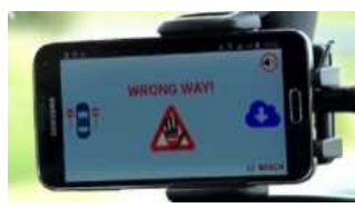
システムにより逆走を検知
