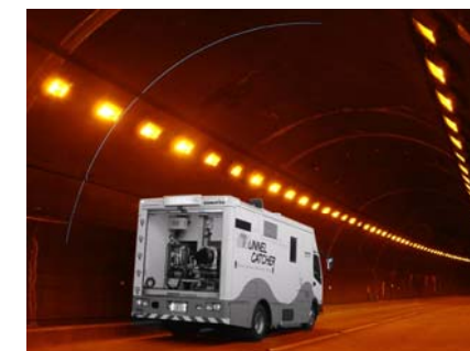
レーザーによる ひび割れの検出
