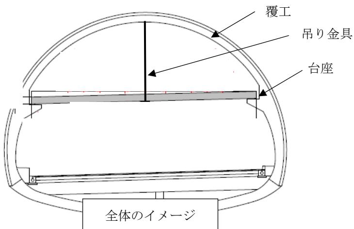
(1) トンネル覆工上部から吊り下げられた鋼材(吊り金具)と天端の固定部(参考写真-1)
