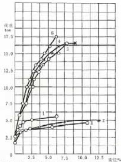
西部バークニア炭法に於ける従来のルーフボルトとケミカルアンカーによる固着試験の比較テスト
