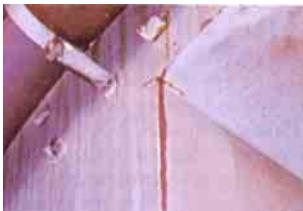
鋼製部材の疲労
