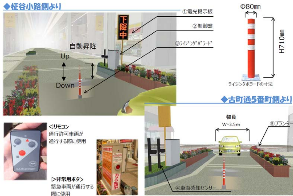
図 ライジングボラードのシステム構成（ふるまちモール6の例）
