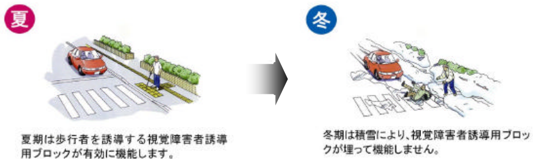
図 11-1-7 視覚障害者誘導用ブロック設置箇所の冬期の問題点
