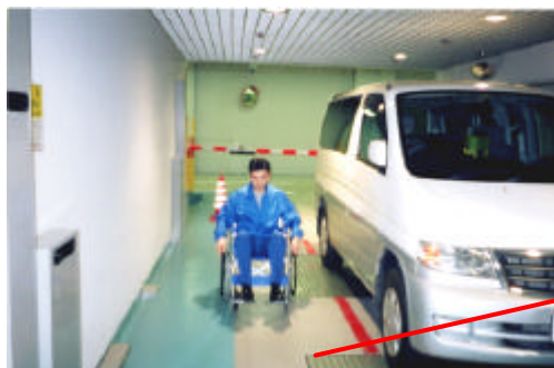
写真一 幅広い乗降バースの設置による乗降スペースの確保（平面往復方式）
