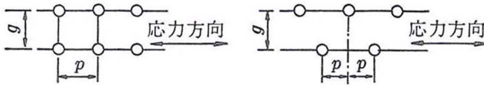
図-4.7.1 ボルトの位置と間隔のとり方
