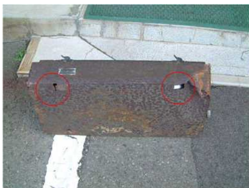
落下照明背面状況
