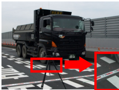
トラックを用いた実橋実測
