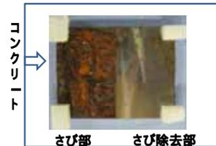
津波被災地多賀城から採取したさびた鉄板を加工し、半分の領域のさびを除去(フライス加工)した。これをコンクリートに埋設し、テラヘルツ波反射強度を測定した。FS研究の予備実験と同様に、さび部からの反射強度が減少した。
