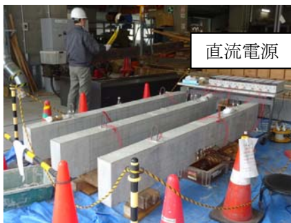
図-4.2 電食試験の状況
