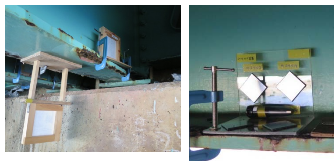
写真 16 腐食環境調査の状況 （塩分、濡れ、腐食速度）
