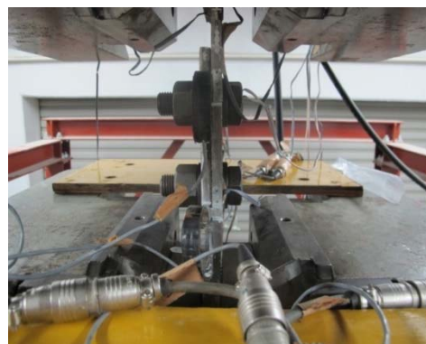
写真8 当て板ボルト工法の試験状況
